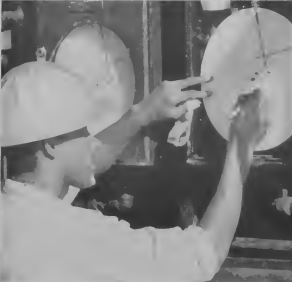
R. Dominico Kelly sets pressure recorder on mooring line from tanks ashore. UGER Dominico Kelly ta pone registro di presion ariba linea for di terra.
